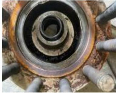
案例 2:河南金大地化工有限责任公司阀门止回阀芯密封面堆积焊渣,导致止回锥无法复位,取出焊渣,冲洗干净故障排除。
