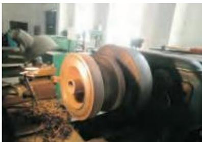
案例 2. 山东京能热力有限公司的阀门在例行检修时更换了全套密封圈,现场为方便安装,在O型密封图上涂抹了白油(矿物油),导致O型密封圈在运行一阶段后硬化,失去密封作用。并且在密封面上冲蚀出两条深浅不一的裂纹。后将裂纹处使用 J422 焊条补焊打磨抛光,并更换全套密封圈。故障排除。
